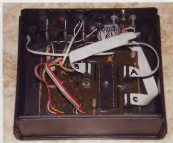
Obr. 6 a 7. Fotografie elektronické části varhaního pedálu
