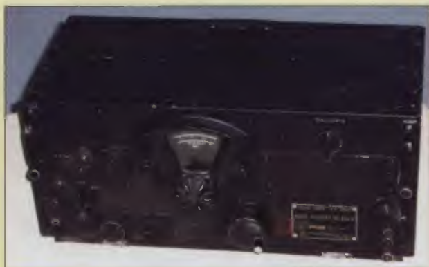
Obr. 3. Prijímač BC-224, verzia D (vľavo)
