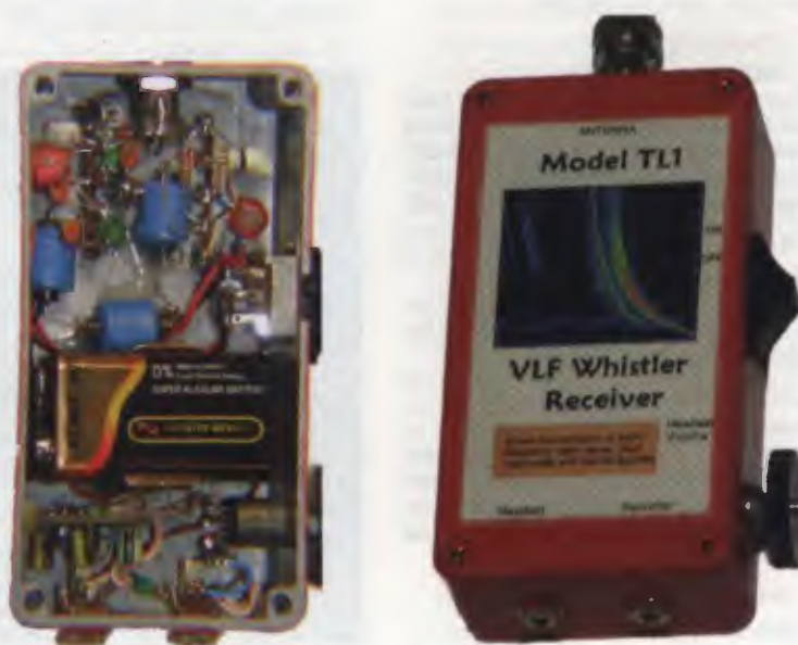
Obr. 3. Konstrukční provedení VLF přijímače Dual-Mode
