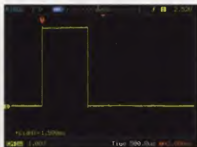
Obr. 2. Servosignál, šířka pulsu 1,5 ms
