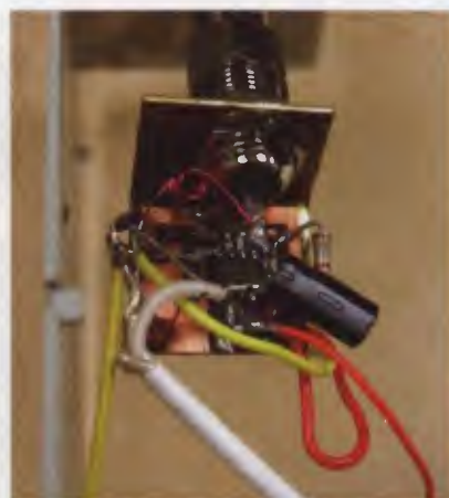
Detailní pohled na destičku mf detektoru a operačního zesilovače s NE5534
