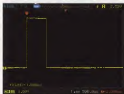
Obr. 3. Servosignál, šířka pulsu 1,0 ms
