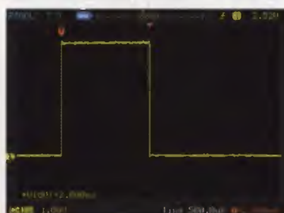
Obr. 4. Servosignál, šířka pulsu 2,0 ms
