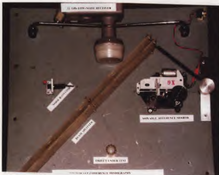
Fotografie MCT (Microwave Coherence Tomography) zařízení, sestaveného na hliníkové desce, se kterým se mi podařilo sejmout zajímavé „signatury“ (vlnky) různých věcí – viz obr. 8. Na fotografii jsou popisky v angličtině, zde je české vysvětlení: 12 GHz Low-noise receiver – LNB jako radiometr; Movable reference mirror – referenční reflektor posouváný vyřazeným mechanismem z přehrávače CD asi o 3 cm při každém běhu, 10otáčkový potenciometr dával napětí pro „osu X“; Object under test – zkoumaný předmět, zde váleček; uprostřed diagonálně Beam splitter – dělič výkonu 50/50 % „optický“, dvě dielektrické desky vzdálené asi 9 mm od sebe; vlevo na úhelníku Noise radiator – šumový zářič s LED (dipólek)
