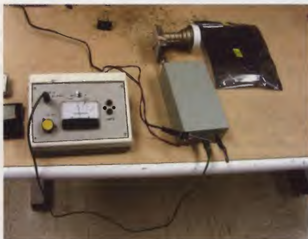
Sestava při měření – mezi LNB a trychtýřem „vysílače“ je vzdálenost asi 30 cm, antistatický sáček položený podélně vykazuje útlum asi 8 dB; napříč má útlum přes 30 dB
