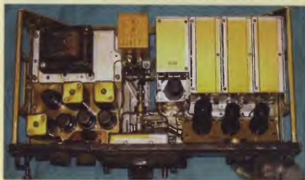
Obr. 5. Pohľad dovnútra prijímača BC-348 vo verzii Q
