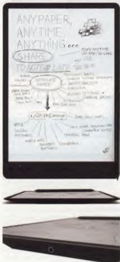
Čelní a boční pohled na NoteSlate a umístění konektorů na spodní hraně
