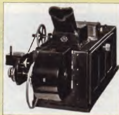
Obr. 26. Zrcátkový oscilograf se záznamem na fotografický papír
