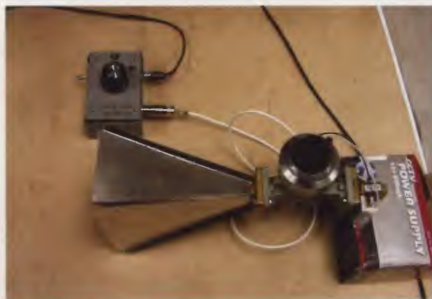
Šumový „vysílač“: klíčovac, šumový generátor ve vlnovodu, vlnovodový zesilovač a trychtýř
