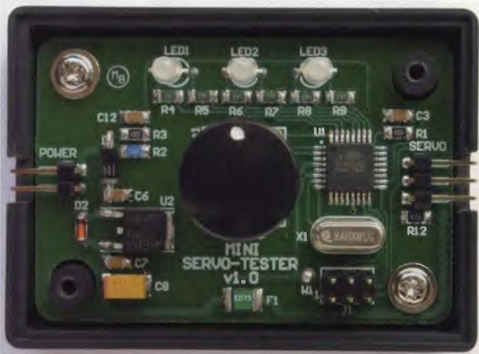
Obr. 11. Deska servotesteru v krabičce
