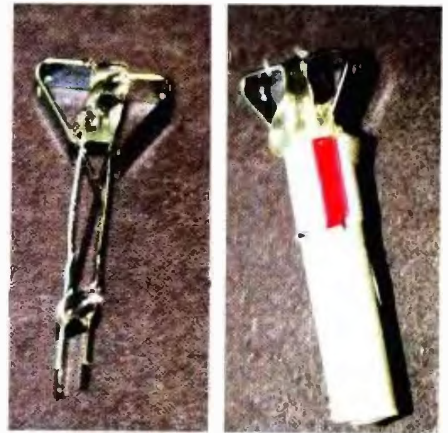
Konstrukce sondy pro měření vlhkosti půdy z kovových elektrod zalitých do sádry
