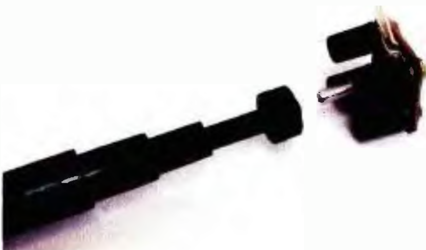
Obr. 16. Svorkovnice na vrcholu teleskopické tyče
