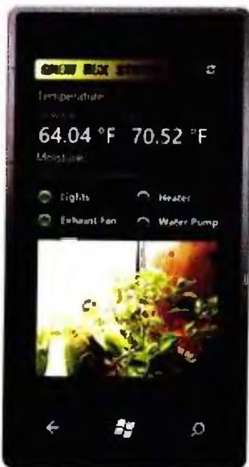
K nastavování a sledování teploty a osvětlení vyhoví jednoduché programy, po připojení k Internetu lze vše včetně záběru vestavěné kamery sledovat i na mobilním telefonu
