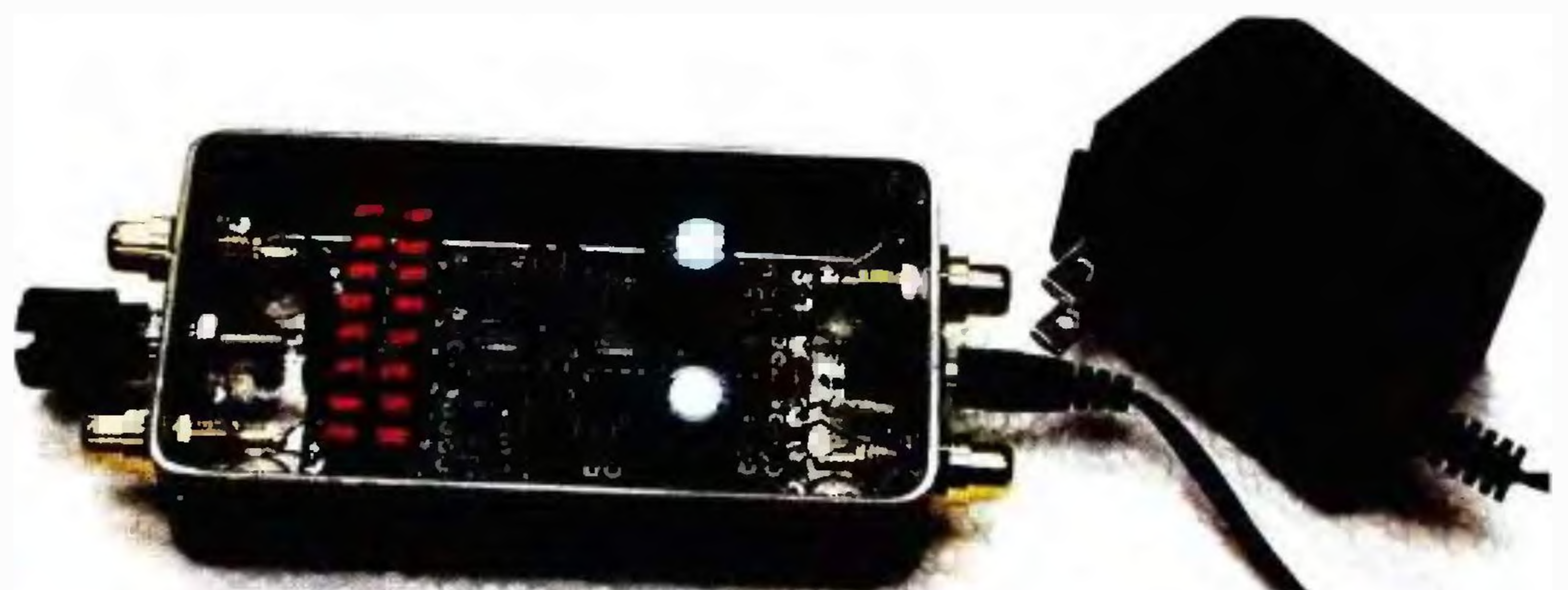
Ukázka továrního řešení předzesilovače s externím napájecím zdrojem
