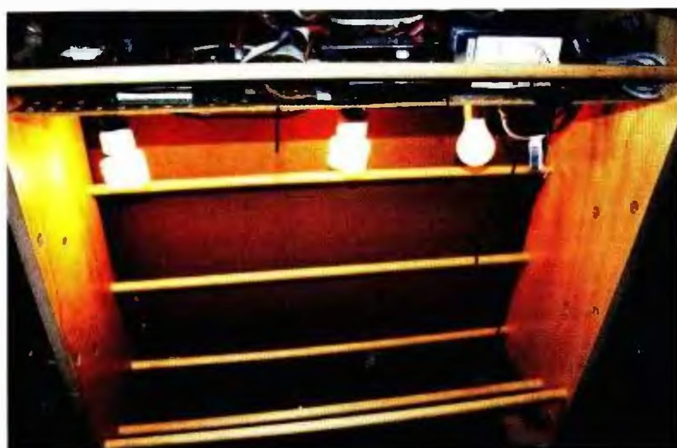
Uvnitř elektronického pařeniště je osvětlení, topení a konstrukce na rozmístění misek (zatím nepoužitá)
