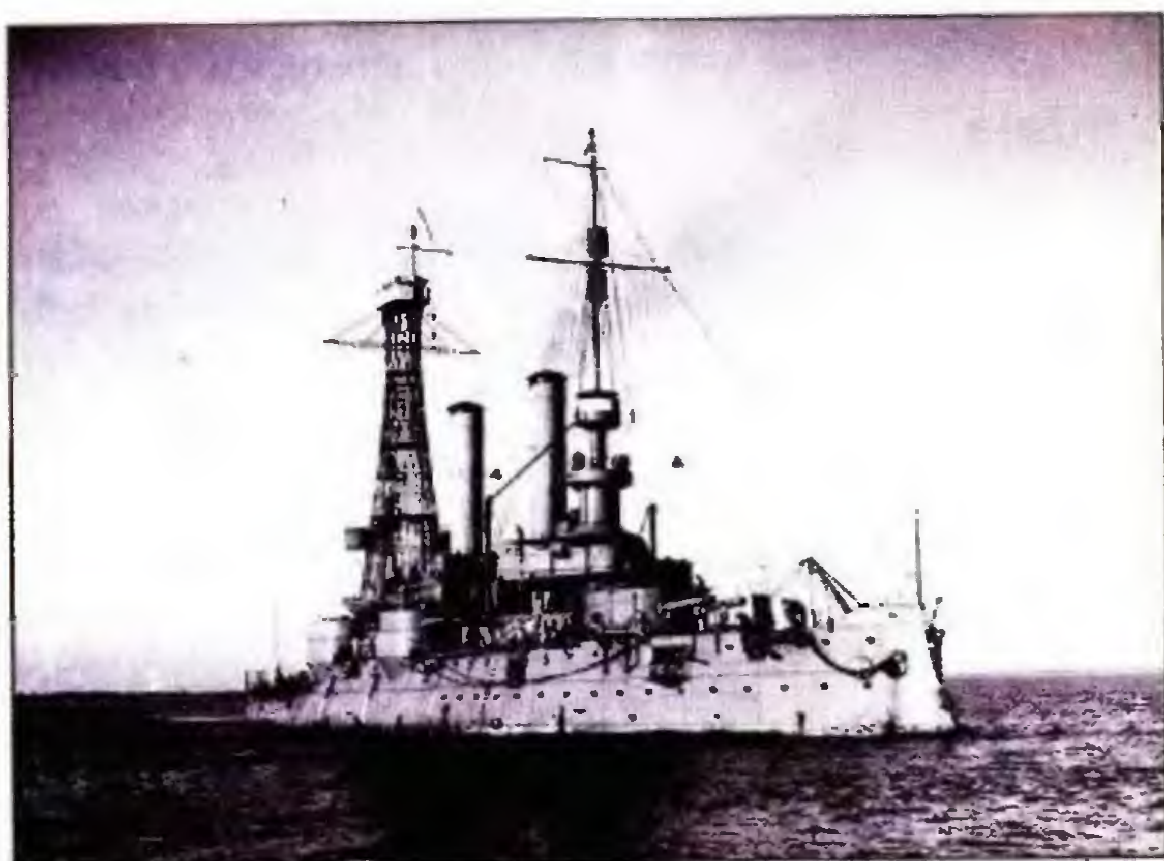
Obr. 16. Bojová loď U.S.S. Iowa s anténami a se zařízením od de Foresta
