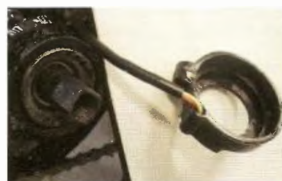
Obr. 9. Generátor PAS magnetický - kompaktní - stator
