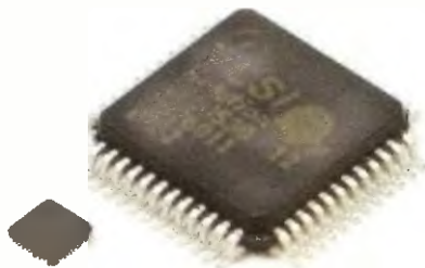
Mikroprocesor VS1053 (vlevo je ve skutečné velikosti 1:1)
