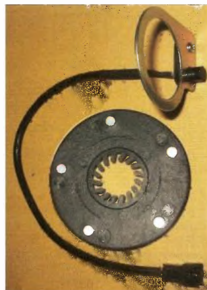
Obr. 8. Generátor PAS - magnetický
