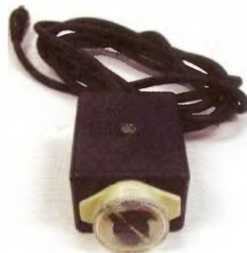
Obr. 8. Indikátor nabíjecího proudu, uvnitř je bočník pro rozsah 400 mA
