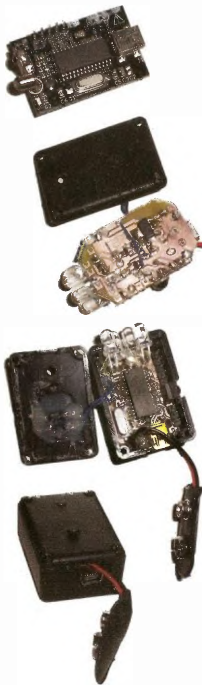
Obr. 4. Konstrukční provedení popisovaného přístroje; nahoře je deska originálního projektu, popisovaná verze je menší
