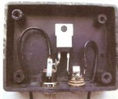
Obr. 7. Krabička, přilepená na zadní straně fotovoltaického panelu, obsahuje výstupní konektor, Schottkyho diodu a konektor s rozpojovacím kontaktem pro indikátor nabíjecího proudu
