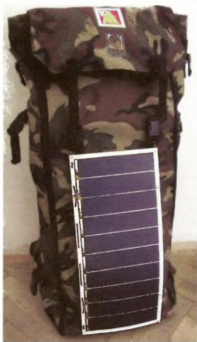
Obr. 5. Pružný fotovoltaický panel typu 10SC1 je upevněn na tlumoku v osmi bodech
