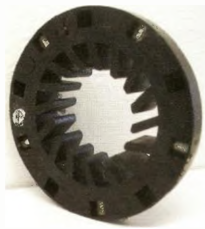
Obr. 10. Generátor PAS magnetický - kompaktní - rotor
