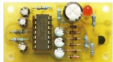
Obr. 4. Deska s součástkami pseudonáhodného blikače
