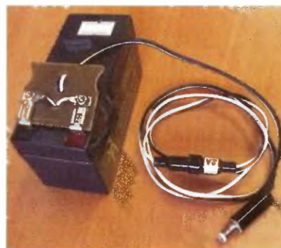
Obr. 9. Gelový akumulátor 1,3 Ah s napájecím kabelem
