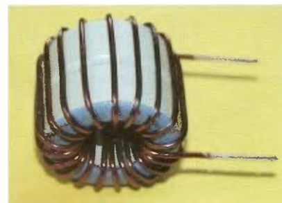
Obr. 4. Navinutá sendvičová akumuláční tlumivka
