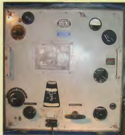
Obr. 11. Krátkovlnný přijímač Lorenz Lo 6 K 39a byl šestiobvodový přímozesilující audion se zpětnou vazbou s rozsahem 1,5 – 25 MHz v osmi podrozsažích. Dlouhovlnná varianta Lo 6 L 39 přijímala na frekvencích 75 – 1500 kHz. Podobný byl i přijímač Telefunken typu E 407 Rø P
