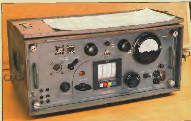
Obr. 15. Měřicí a přehledový superheterodyn „Fanö“ (FuMB 5) RS 1/20 DM43 firmy PTE (R & S) pro příjem v pásmu 400 – 800 (1600) MHz pro varování před radary na ponorkách
