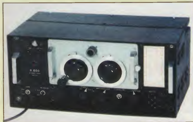
Obr. 16. Obr. Pro varování ponorek před radary sloužil i přijímač (FuMB 1) Metox Grandin z Paříže, typ R600 s rozsahem 113 – 960 MHz.
