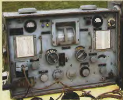
Obr. 14. Pětivattový přijímač-vysílač Hagenuk Ha 5 K 39c s rozsahem 3 až 6 MHz používaný u motorizovaných námořních jednotek a na malých lodích
