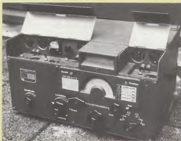
Obr. 12. Superhet Telefunken E 52 („Köln“ T 8 K 44) s rozsahem 1,5 – 25 MHz měl 2 vř předzesilovače, 3 stupně mezifrekvenčních zesilovačů, s dvojitým variabilním krystalovým filtrem 0,2 – 10 kHz
