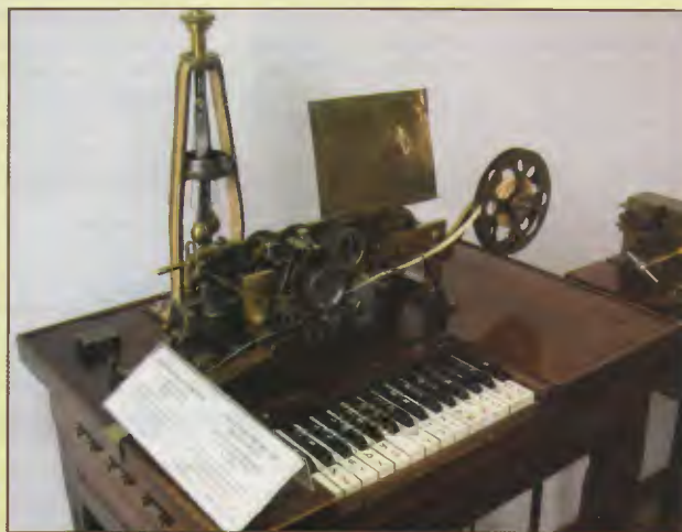
Obr. 4. Ruský model Hughesova přístroje z roku 1900 (výrobce Siemens-Halske) s otevřeným odstředivým regulátorem otáček, vystavený v technickém muzeu v Petrohradě. Za pozornost stojí i dvojnásobným zkomolené jméno vynálezce (Hughes – Juz – Use) na muzejním štítku
