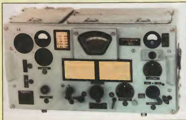
Obr. 17. Pro zaměřování na pobřežích se používal superheterodyn Telefunken T8 (P) L39 „Martin“ s křížovou goniometrickou zaměřovací anténou
