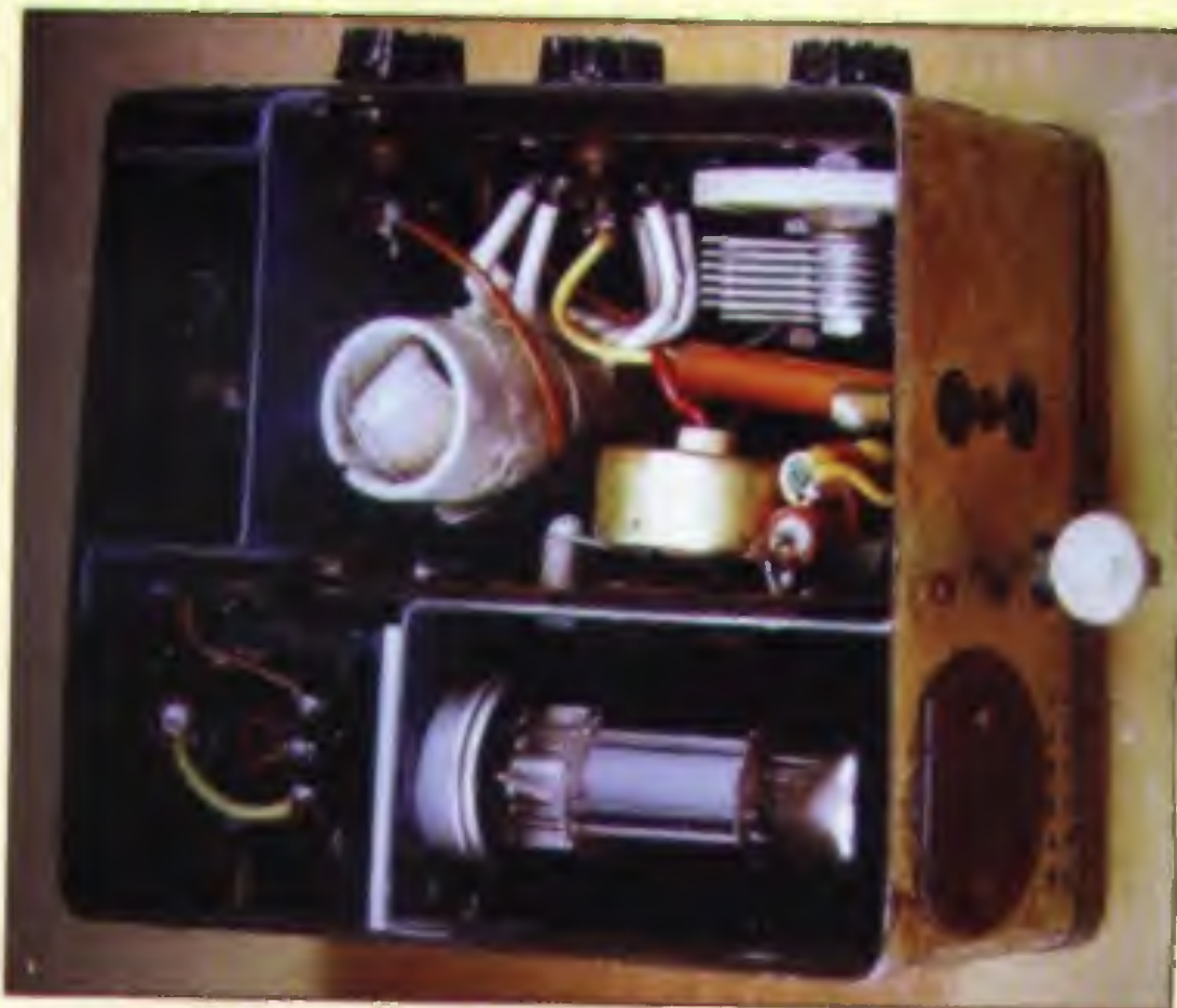
Obr. 4. Jednotlivé díly se snadno a rychle navzájem propojovaly speciálními konektory, zvanými „Breckkopplung“
