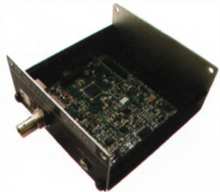
Obr. 14. Montáž desky přijímače PM-SDR do kovové skříňky
