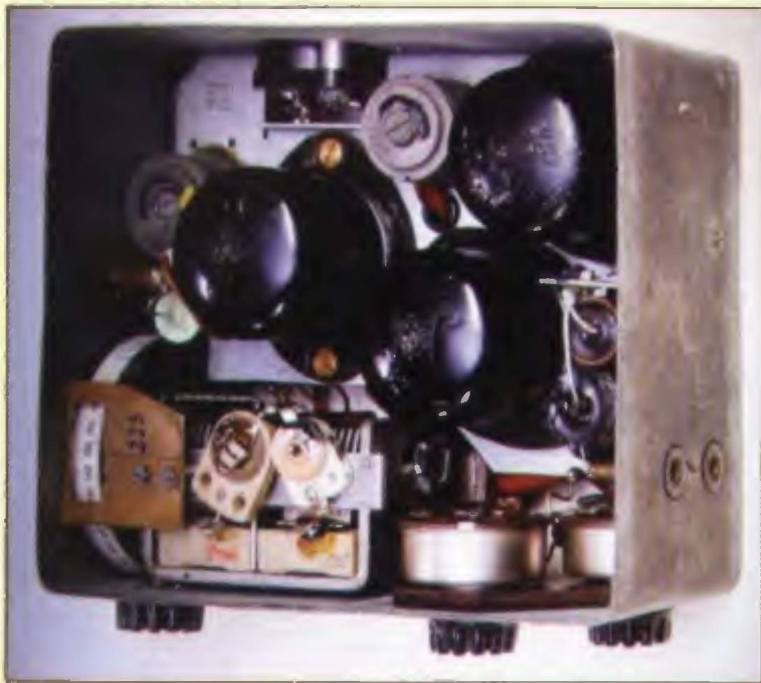
Obr. 2. Přijímač má dvě elektronky EF12 a jednu EDD12
