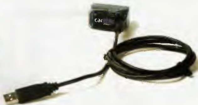
CarChip Pro (nahore ve skutečné velikosti) se připojí k počítači kabelem USB (dole)
