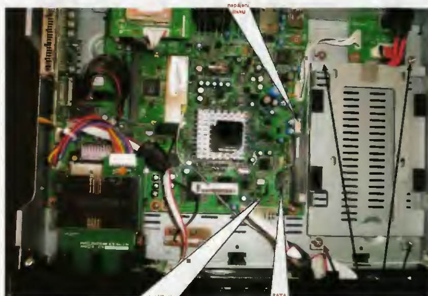
Pohled na základní desku přijímače AzBox Premium HD, vpravo místo pro pevný disk
