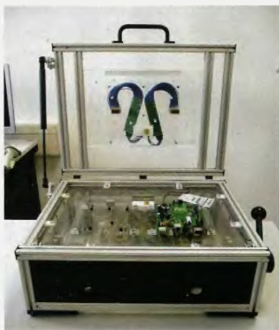
Fixtura - kontaktní jehlové pole, které slouží k testování osazených desek
