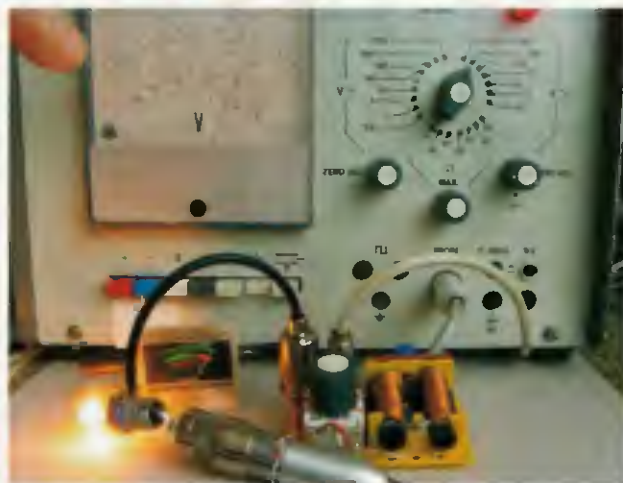
Obr. 4 a 5. (Vpravo a vlevo nahoře) Dva pohledy na ladící anténní jednotku vlastní výroby, s popisem
