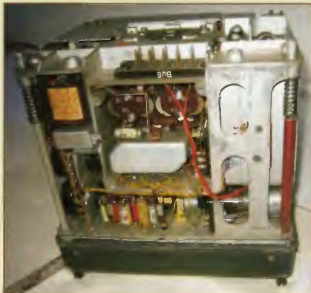
Obr. 1 až 3. Tři pohledy na přijímač E10k3: přední panel, pohled zespoda (vlevo) a zleva na přijímač bez krytu
