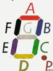
Obr. 1. Rozmístění segmentů displeje LED
