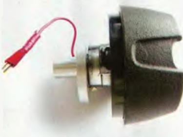
Obr. 18. Sestava chladiče výkonové LED a reflektoru svítilny
