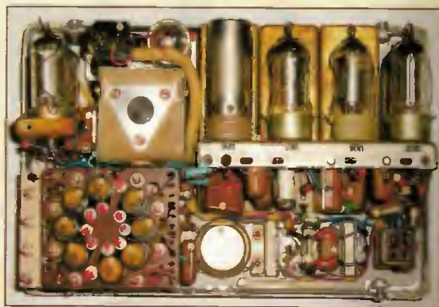
Obr. 3. Pohľad na vnútornú konštrukciu prijímača
