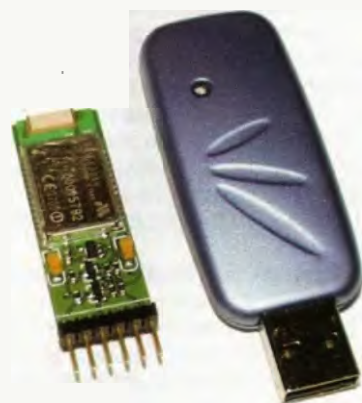
Modul SMiRF a běžný USB Bluetooth adaptér pro PC
