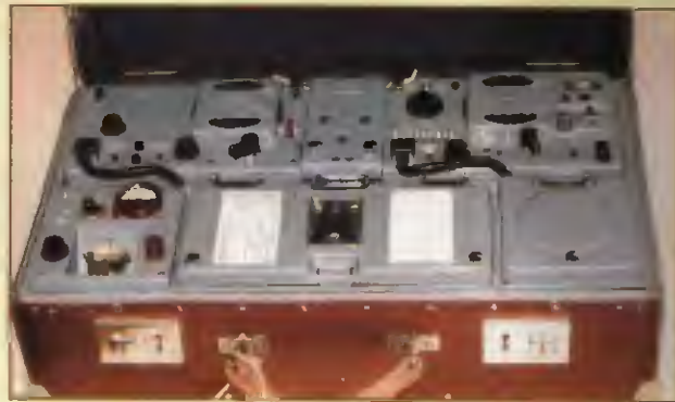
Obr. 1. Uloženie rádiostanice v klasickom kufri
