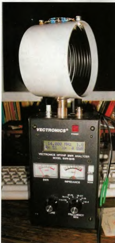
Obr. 3. Měření balunu, zakončeného odporem 50 Ω (8 x 100 Ω) anténním analyzáteřem
