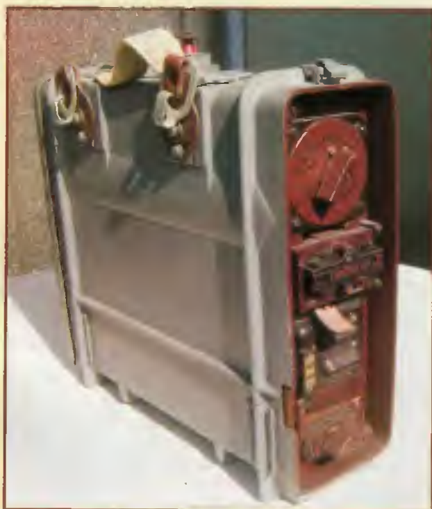
Obr. 1. Zrenovovaná radiostanice typu Feld Fu c. po asi šestašedesáti letech (vlevo)
