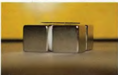
Obr. 16 a 17. Diamagnetické materiály silné magnetické pole odpuzuje
