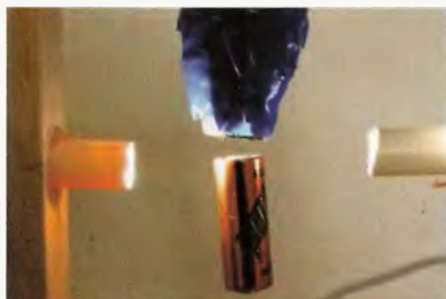
Obr. 21. Detail na fotobunku, vznášajúcu sa batériu a elektromagnet
