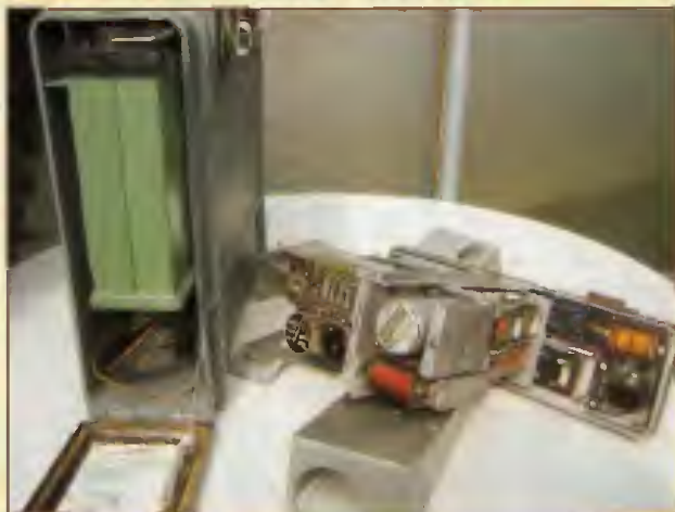
Obr. 3, 4. Nahoře detail vibračního měniče Wgl2,4a; dole radio-stanice Feld Fu c. vyjmutá ze skříňky
