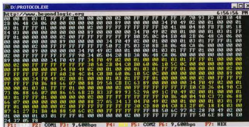
Obr. 4. Protocol Analyser pracující v režimu Hex Mode. Bílé jsou zobrazena odeslaná data, žluté jsou pak zobrazena přijímaná data
