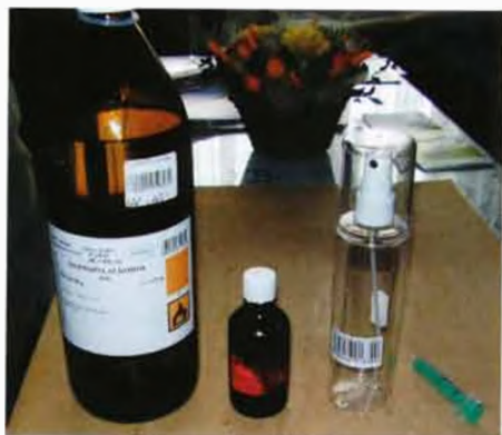
Obr. 1. Potřebné položky pro svépomocné čištění kontaktů: zleva isopropylalkohol, parafinový olej, mechanický rozprašovač, injekční stříkačka
