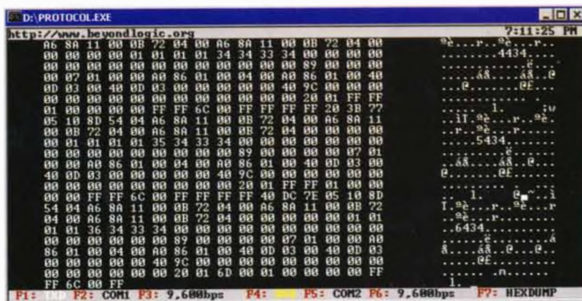
Obr. 3. Protocol Analyser pracující v režimu HexDump
