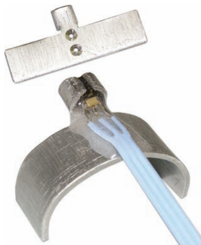
Obr. 8. Mechanická konštrukcia teplotných senzorov
