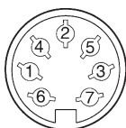
Obr. 4. Některé transceivery ICOM mají informaci o pásmu vyvedenou na konektoru ACC(2), vývod 4
