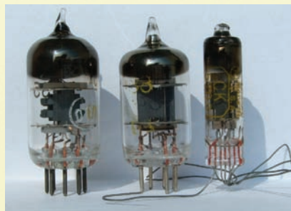
Elektronky 6F35, 6F32V a její ekvivalent s drátovými vývody (USA). Klasická 6F32 má rozměry stejný s 6F35
