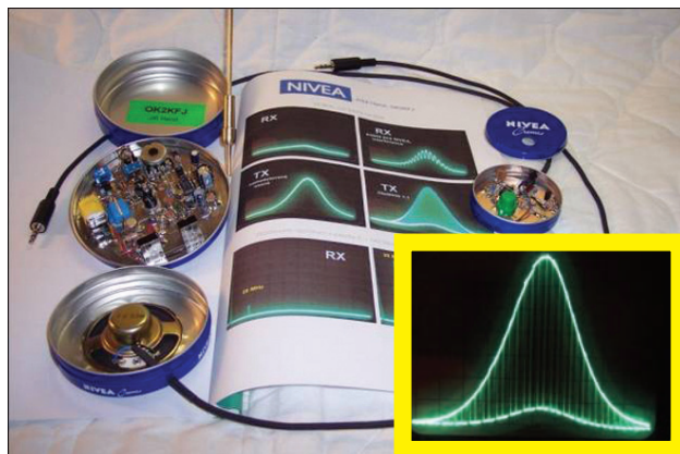
Pohled dovnitř jednoho soutěžního Rádía NIVEA (vlevo). Elektrické parametry Rádií NIVEA byly vyhodnocovány na špičkových měřicích přístrojích...
