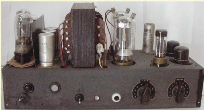
Obr. 1. Fotografie mého historického nf zesilovače s elektronkami RL12P35
