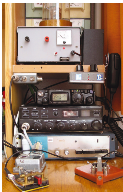
Obr. 1. Vysílací pracoviště OK1ACP. Transceiver FT-817 uprostřed, nad ním anténní členy, nahoře napájecí zdroj a reproduktor; pod ním transceiver Cleanstone pro CB a 28 MHz a stanice TESLA VR-20
