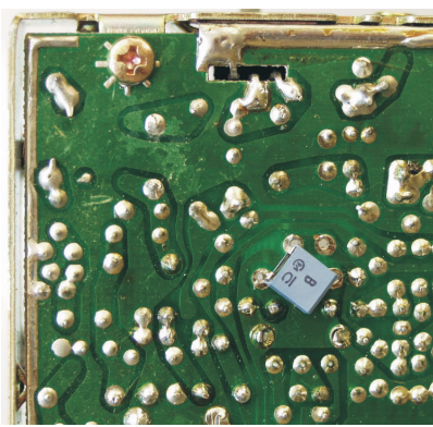
Obr. 3. Keramický filtr muRata SFGCG455-BX-TC v provedení SMD
