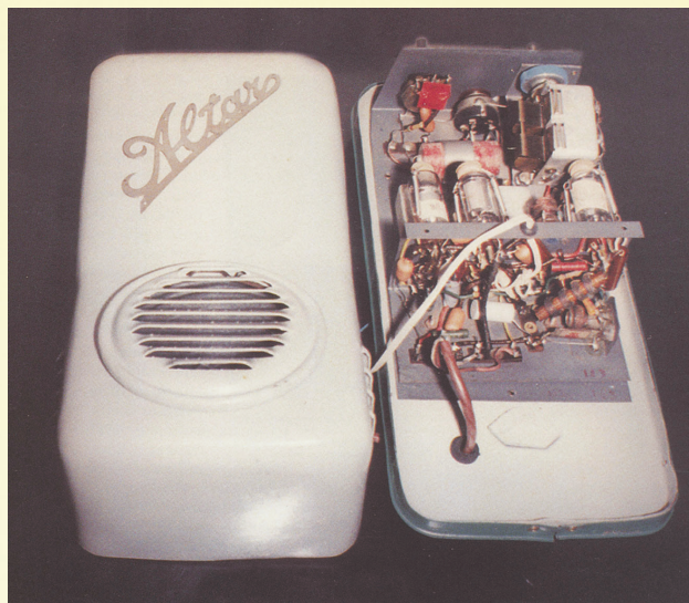
Obr. 1, 2. Motorádio. Vlevo na skútru, vpravo bez krytu
