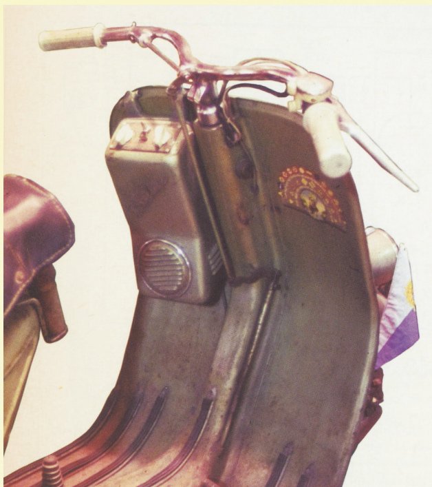
Obr. 1, 2. Motorádio. Vlevo na skútru, vpravo bez krytu
