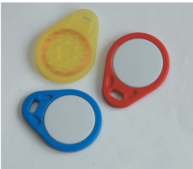
Obr. 7 a 8. „Klíčenky“ s transpondéry a osazená řídicí deska
