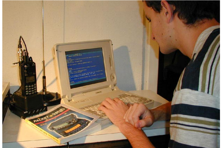
Jednoduché pracoviště pro provoz PR: zleva FM transceiver ALINCO DJ-191, pod ním modem GC12AX, vertikální anténa pro pásmo 145 MHz, notebook s procesorem 486 a kniha „Packet radio od A skoro až do Z“
