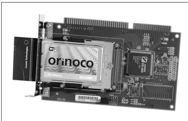
ISA adaptér (umožňuje vložení karty PCMCIA do běžného stolního PC) - výrobek firmy EASTNET
