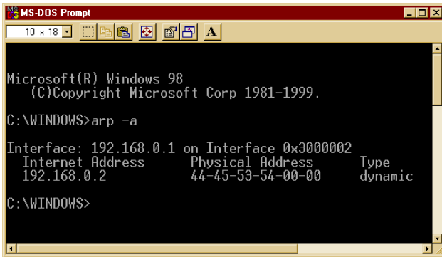
Obr. 4. Utilita arp.exe zobrazí vzájemné přiřazení MAC a IP adres
