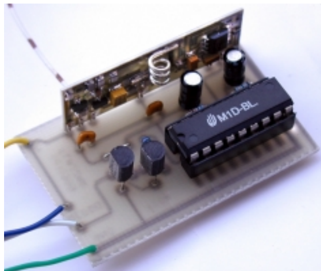
Obr. 9 a 10. Fotografie osazené desky vysílače a přijímače s vř moduly
