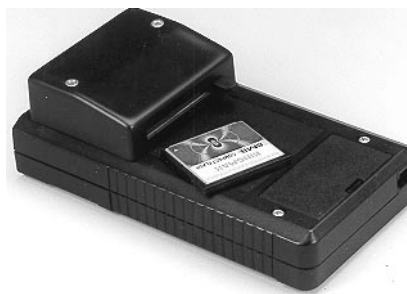
Obr. 6. Karta CompactFlash jako vnější paměť mikro počítače
